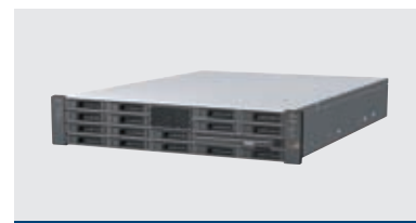
最大16ディスクドライブ搭載構成
